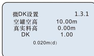
选择物料性质为微DK时，一般用于介电常数小于1.4，这时介质表面的直接回波很弱，或不能测量，而通过罐底反射的方法可以测得料位高度，这时需要输入以下参数中的两个：
