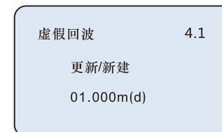
提示输入真实回波距离值，输入距离值后，按OK键确认，液晶显示请等待，仪表进行虚假回波的学习，完成后退到虚假回波学习菜单。
