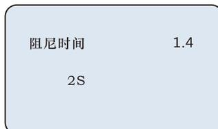
按OK键进入参数编辑状态，用 $\leftarrow$ 键设置数字，用 $\rightarrow$ 键选择编辑数字位，编辑完成后按OK键确认。
