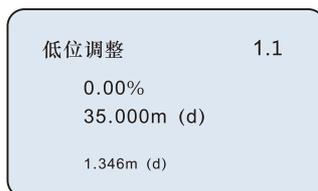
按OK键，进入编程低位百分比，参见前述参数编辑方法中字符/数字参数编程方法编辑百分比值及距离值。编辑完成后，按OK键确认，按BK键放弃编程。
