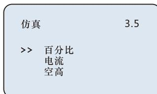
用 $\leftarrow$ 键选择电流输出映射方式，按OK键确认，进入相应的设置菜单，完成数值设置后，按OK键确认，此时，相应的电流输出设置值所对应的电流值。
